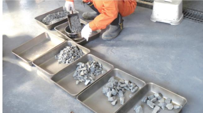
体験当日は碎石生産品質管理業務を体験させていただき、主に道路用の路盤材C40試験の作業を行いました。碎石を9種類の金網でふるい分けて、粒度分布のデータを作成する作業です。種類ごとに重量を計ることで粒度のバラツキが分かります。
