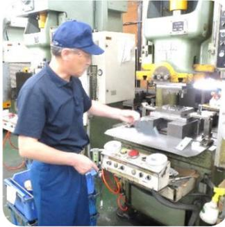
昭和50年4月1日設立。精密プレス板金加工・金型加工、NCレーザー及びNCタレットパンチプレスによる板金加工を製造する会社です。製造部門は板金・ベンダー・プレス・その他部門に大別。二次的受注二次的受注を幅広く手掛け、20代30代の若者や女性のオペレーターが活躍しております。主要加工品目はOA機器等の電子部品および工業部品多品種、小ロットにも対応しています。ベンダー部門は、ベンダー(曲げ加工機)を用いて、ワーク(金属)を型に合わせて特定の形状や角度に変形させる加工のことで、プレス部門は、45トンから250トンクラスのプレス機を使用し、OA部品などを鉄板で抜き・曲げ加工を行う作業です。専用の金型に加工します。当日はベンダー加工された製品をかごに入れる作業、製品を梱包する作業を体験しました。
