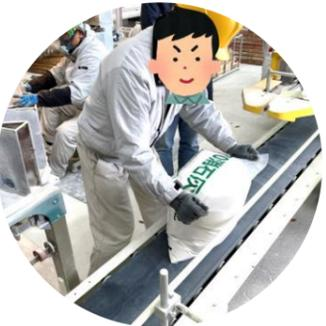
北上石灰門崎工場では主に肥料用消石灰が製造されています。当日は、肥料用消石灰製造部門の製造工程を学びました。体験作業では、ポリ袋20kgを1パレット(1段5袋×10段積み=50袋)で、ローテーション積み数を数回行いました。体験後、工場内を視察しながらオペレータ室(総合監視盤で製品や製造量を調整)を見学しました。
